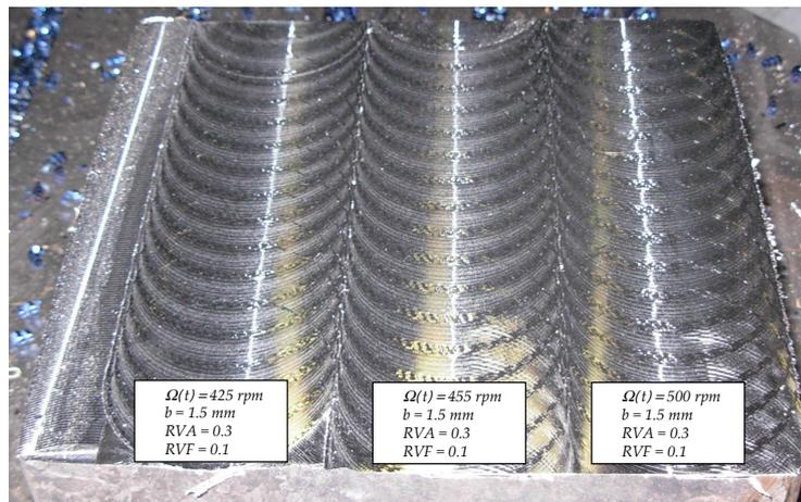
**Figura 5.27:** *Effetto di vibrazione pulsante sulla superficie del pezzo in tre differenti lavorazioni.*
