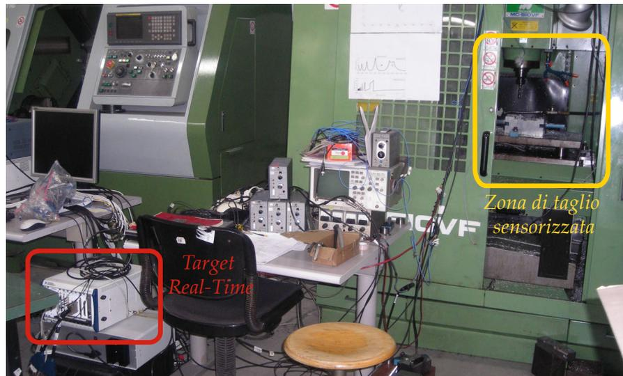
**Figura 5.7:** Centro di lavoro *Matsuura MC-510VF* e sistema di misura.
