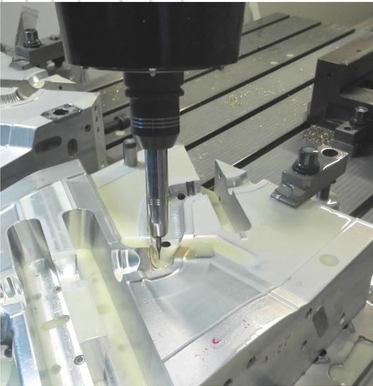
TENDO E compact è il best seller SCHUNK dalle elevate prestazioni, che permette un incremento della durata utensile fino al 300% rispetto ad un mandrino idraulico tradizionale. Per lavorazioni di precisione TENDO E compact può essere attrezzato con le prolunghe TENDO SVL ad ingombro ottimizzato per lavorazioni precise in punti difficilmente accessibili ad esempio nella lavorazione degli stampi. Si attuano con una sola semplice operazione riducendo i tempi di preparazione.
